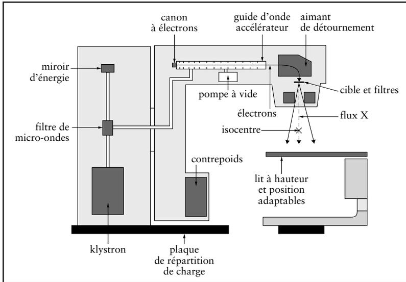
**Figure 26.10** Schéma d'un accélérateur linéaire actuel. Les éléments principaux sont l'amplificateur micro-ondes (klystron ou magnétron), le canon à électrons, le guide d'onde accélérateur, les aimants de détournement et la tête de l'accélérateur, qui inclut la cible, les chambres d'ionisation (non représentées), les filtres égalisateur pour les photons ou diffuseur pour les électrons (non représentés).
